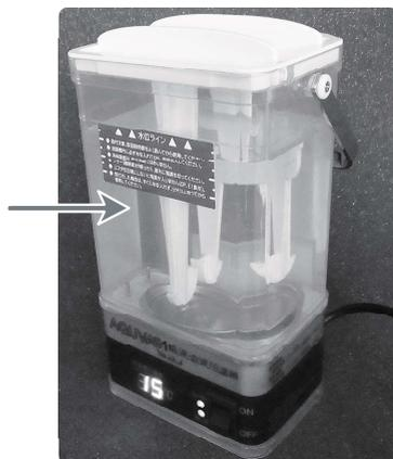
7. 加熱コイル(別売「ウォーマーコイルM型」)に輸血セット、血液回路、輸液セットなどを接続し、生理食塩水で満たす。
